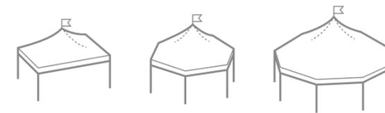
Ce produit, de forme rectangulaire à hexagonale, est donc destiné aux possibilités de développement les plus diverses. Les structures en aluminium placées sous la toiture en PVC améliorent l'esthétique et la ligne d'horizon de l'événement.
