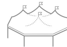
Une solution unique et singulière, avec Meeting nous réussissons à créer un seul espace interconnecté sans séparations ni colonnes centrales. La structure porteuse tubulaire interne souligne le design de la toile de couverture qui, vue de l'extérieur, devient une surface libre et dynamique. Le côté le plus large de la structure octogonale est de 6 mètres.
